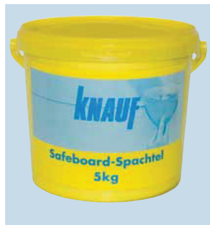
Safeboardi pahtlimass kaitseb kiirguse eest ja takistab kiirgusleket. Safeboardi pahtlit kasutatakse ilma vuugilindita.
